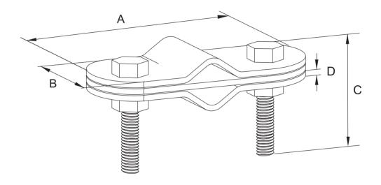
Предназначен для параллельного соединения токоотводов большого сечения  $\emptyset 8-20$  мм.
