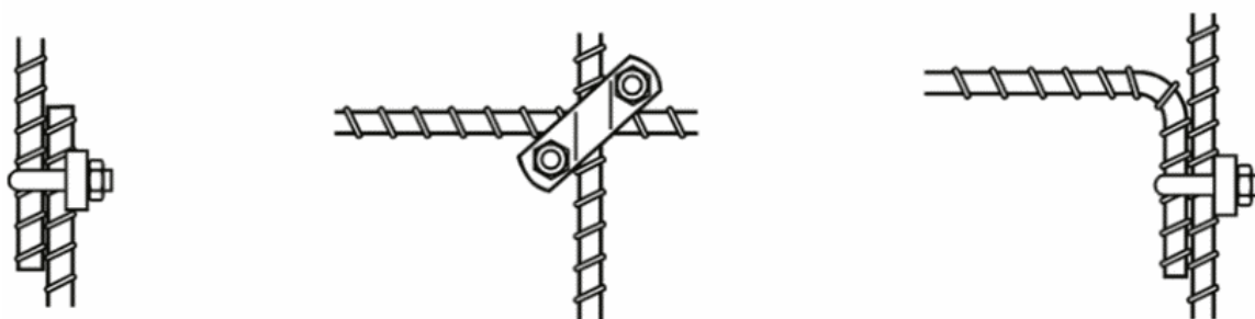
б) Соединения с помощью зажима в соответствии с ГОСТ Р МЭК 62561.1 (для тока молнии и целей ЭМС)
