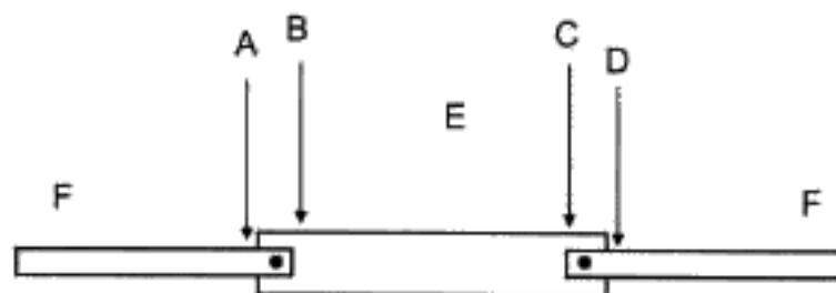
A-B, C-D – точки измерения сопротивления контактных соединений;
